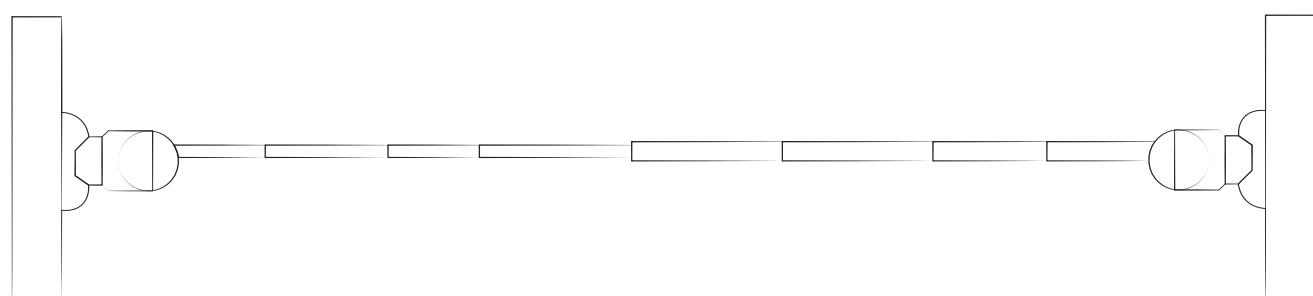
La estructura es realizada con dos guías de deslizamiento de aluminio y tubos extensibles de aluminio.
