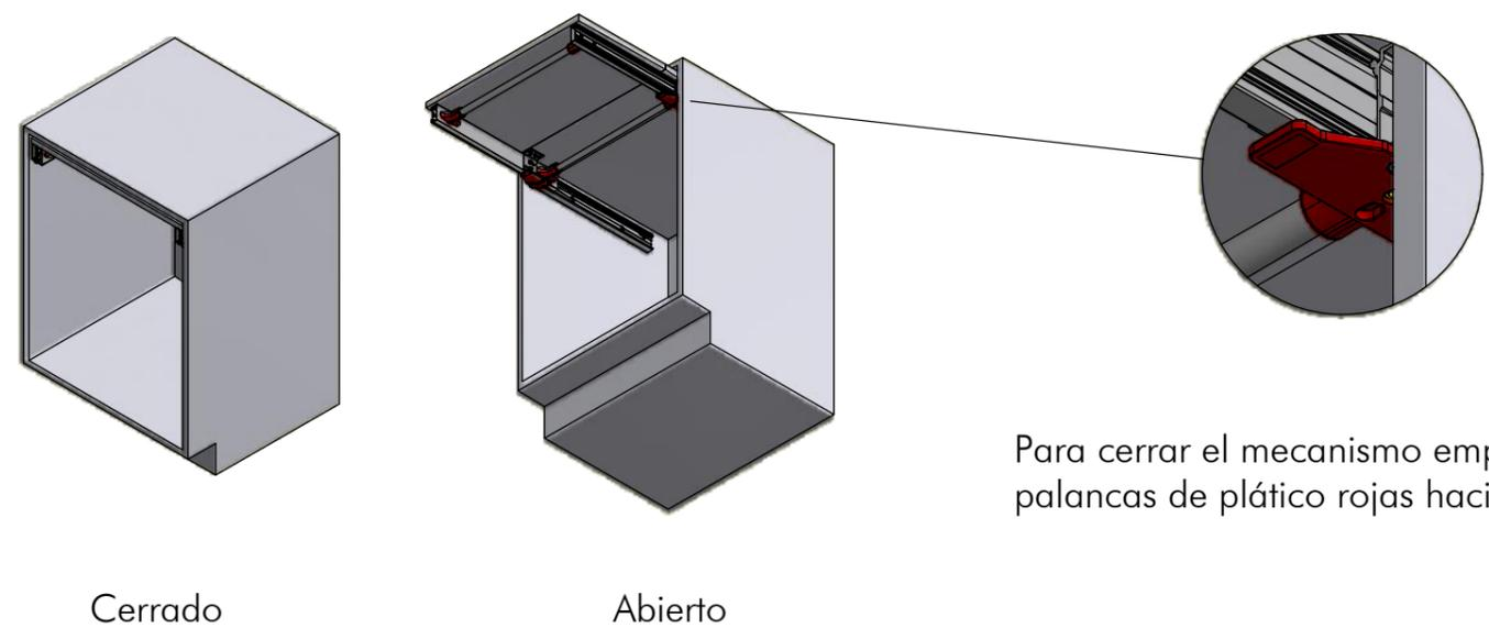
Para cerrar el mecanismo empuje las dos palancas de plástico rojas hacia el interior
