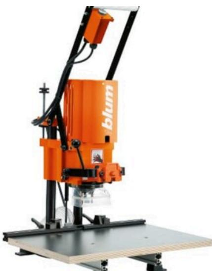
Como especialista en taladrado y colocación de herrajes, funciona con corriente eléctrica y no requiere el uso de aire comprimido.
