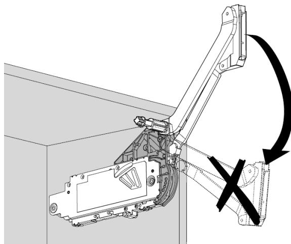
No empuje el conjunto de la palanca hacia abajo sin que la puerta esté colocada
