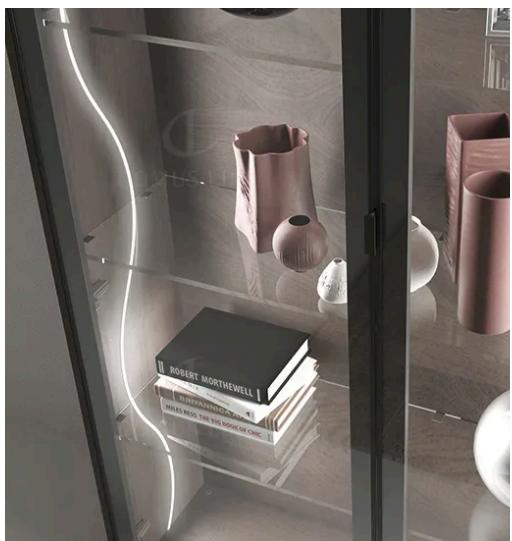
Luces para muebles FLEXYLED en una cinta flexible de LED de 24V, fabricada en silicona difusa. FLEXYLED está diseñada específicamente para la instalación insertada/empotrada sobre ranuras de 4 mm de ancho y 8 mm de profundidad, quedando a ras del panel o superficie.
