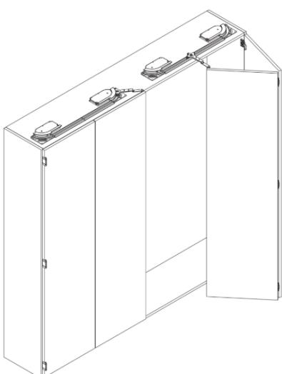
Es un conjunto innovador de herrajes y accesorios que permite que las puertas de madera se abran y deslicen sin necesidad de un carril en el piso. Está compuesto por un brazo superior y bisagras con apertura de 180°, que garantizan un movimiento suave y preciso.
