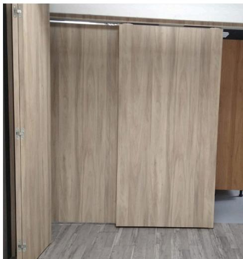
DRAG es un sistema innovador de puertas corredizas que permite conectar hasta tres hojas, accionándose con solo halar una de ellas. Gracias a su instalación superior, ofrece un deslizamiento suave y elimina la necesidad de un carril en el piso, brindando una entrada completamente libre de obstáculos.
