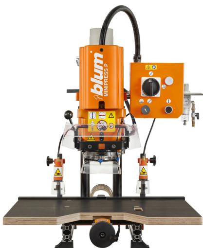
Minipress P es una máquina versátil que permite mecanizar bisagras y bases, además de aventos y guías, permiten taladrar e insertar herrajes con precisión. Una vez configurada, realiza trabajos rutinarios con precisión y eficiencia. Un avance neumático para taladrar e insertar, así como un husillo para ajustar la distancia de taladrado, hacen que trabajar con la MINIPRESS P sea seguro y preciso.
